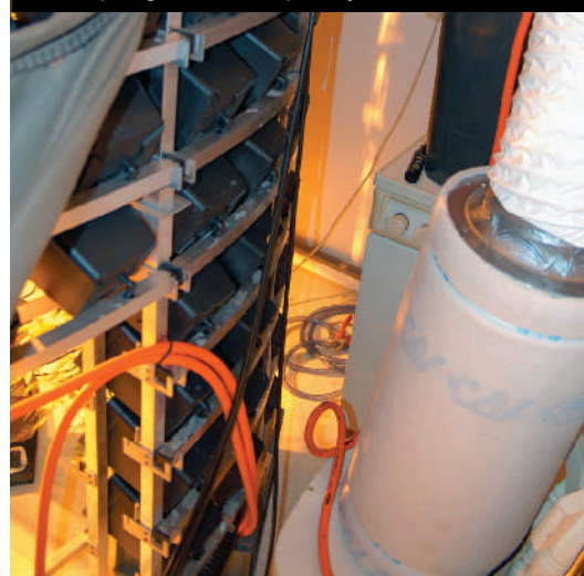
De koolstoffilter en het kliko-voedingsvat. Door de opening linksonder kun je het systeem in
